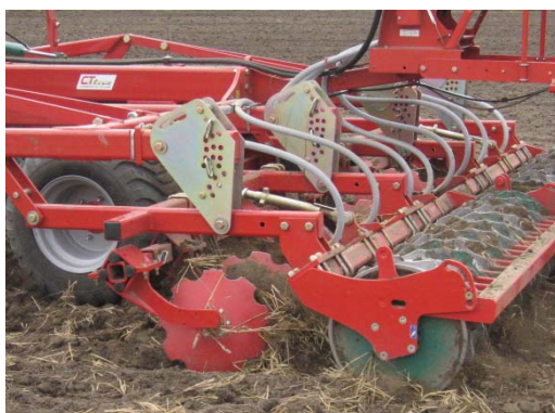
Billede 50. Udsæden bredspredes før pakvalsen.
