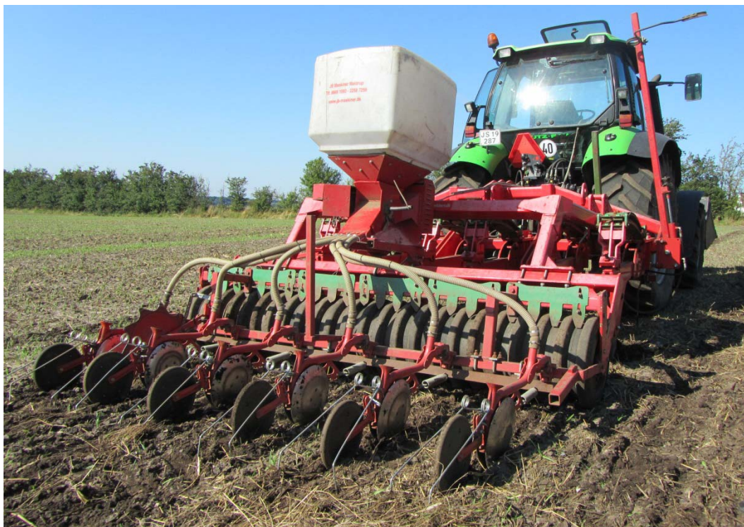
Billede 54. ScanGrubberJB er grundlæggende en grubber monteret med dobbelte skiveskær.
