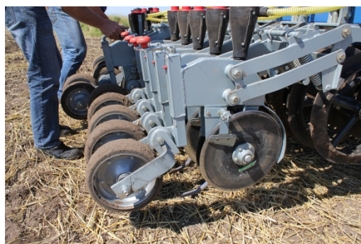
Billede 19. Juri skiveskær med dybdestyringshjul.
