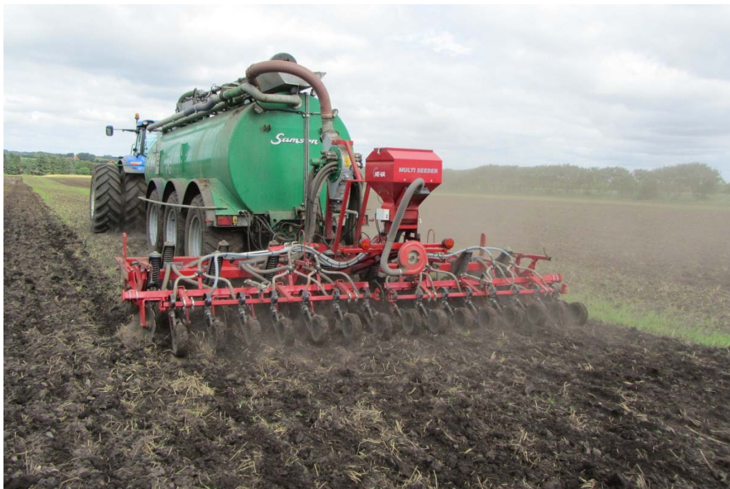
Billede 32. Horsch Focus CS. Gyllenedfældning og rapssåning samtidig.
