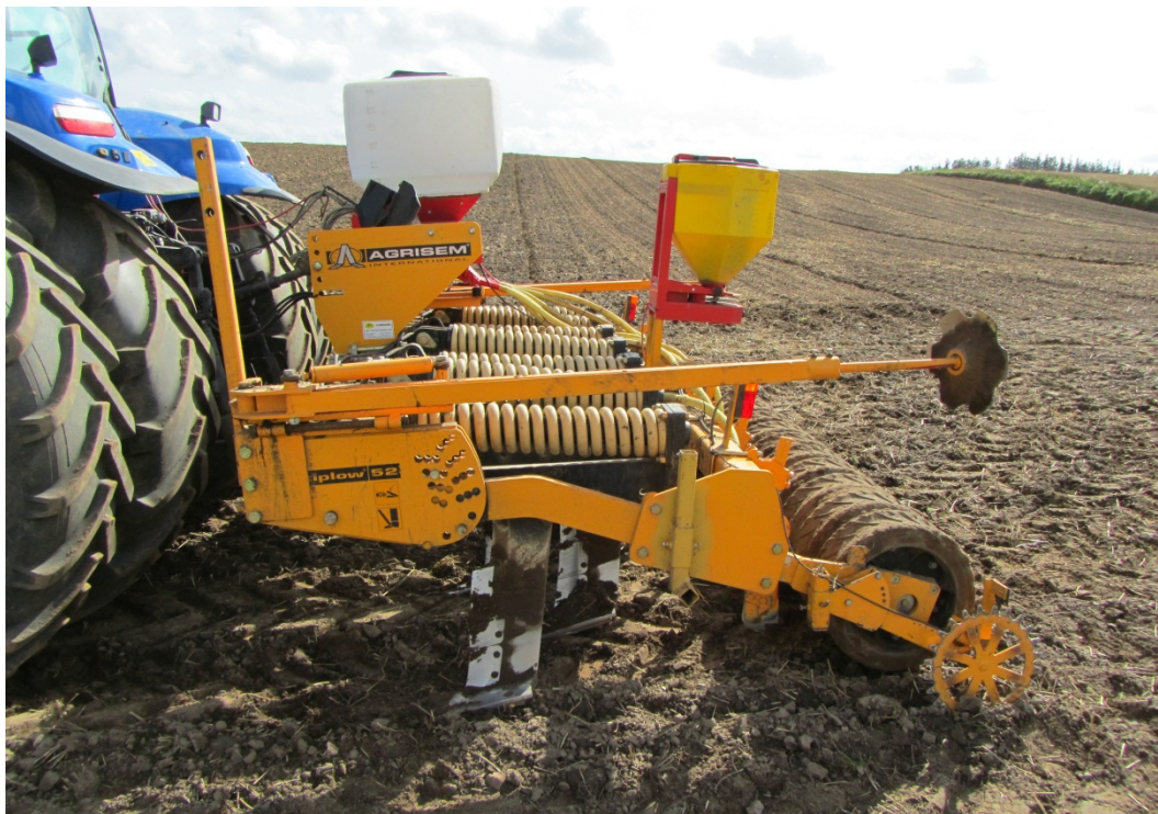
Billede 1. Agrisem Cultiplow Seeder er en kompakt maskine. Jorden løftes af grubbetanden.
