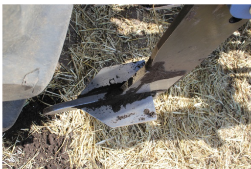
Billede 18. Tænderne er, på grund af vægt, rykket frem.
