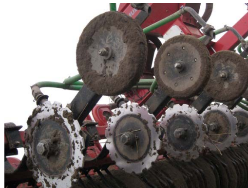
Billede 26. Enkelt-skiveskær med dybdestyringshjul.
