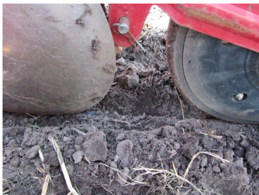
Billede 57. Perfekt frøplacering med skiveskær på den relativt lette jord. Dybdestyringshjul og efterharven lukker sårillen.
