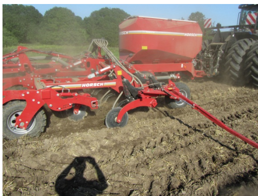
Billede 45. Fokus TD foretager en grundig bearbejdning af jorden før såning ved dyb harvning.
