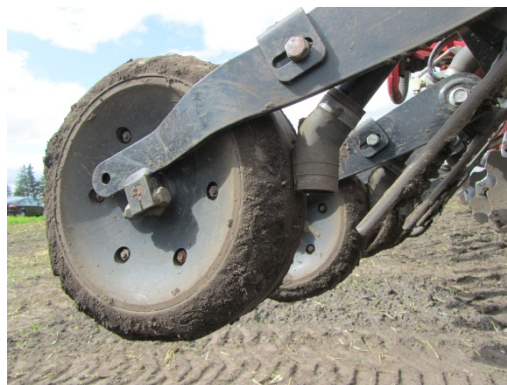
Billede 34. Udløb af raps-udsæden foran trykhjul.
