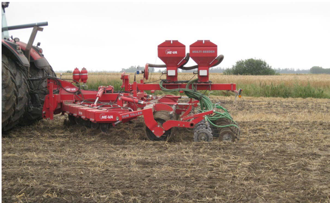
Billede 24. HE-VA Sub-Tiller monteret med en ekstra pneumatisk såkasse til udlægning af sneglegift.
