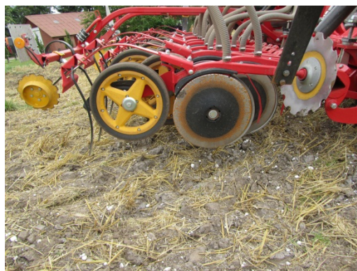
Billede 64. Skiveskær med dybdestyringshjul.
