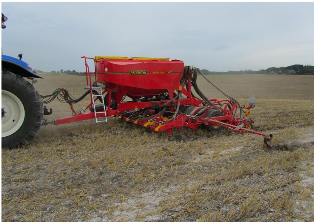
Billede 62. Forreste redskabssektion på maskinen kan udskiftes. Her er Strip-Till sektionen monteret.
