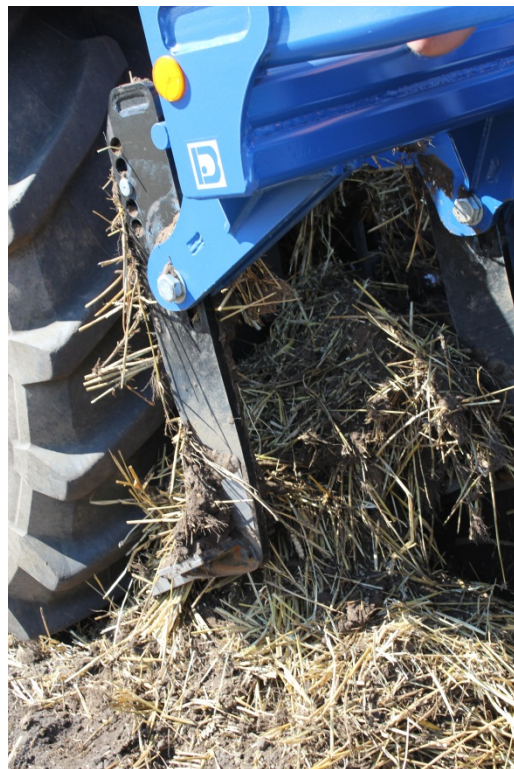
Billede 21. Store mængder frisk halm og grubbetænder placeret næsten på række er ikke nogen god kombination.
