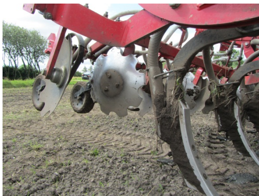
Billede 33. Placering af gylle efter harvetand.
