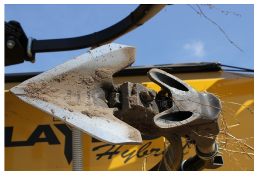
Billede 10. Dobbelt såudløb efter vingskær.
