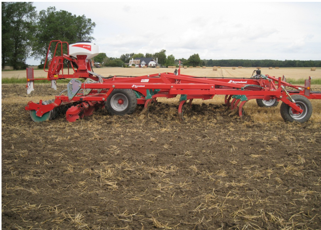
Billede 49. Kverneland CTC's stålpakkevalse muldrer det øvre jordlag og efterlader en jævn overflade.
