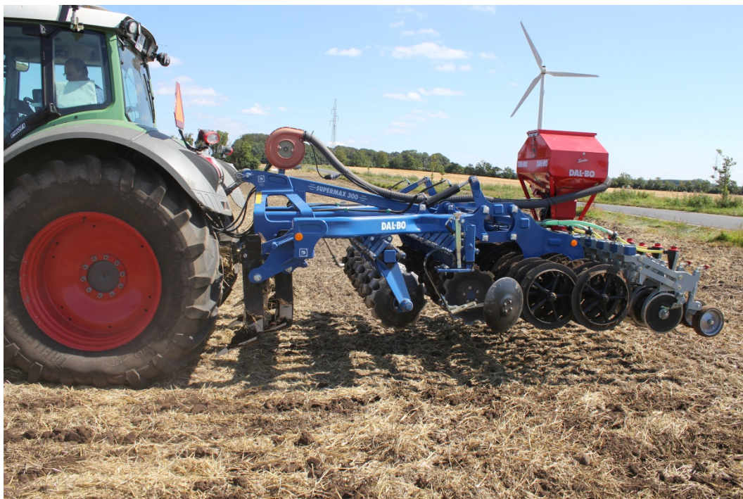
Billede 17. Dal-Bo foretager både grubning og jordbearbejdning før såning.
