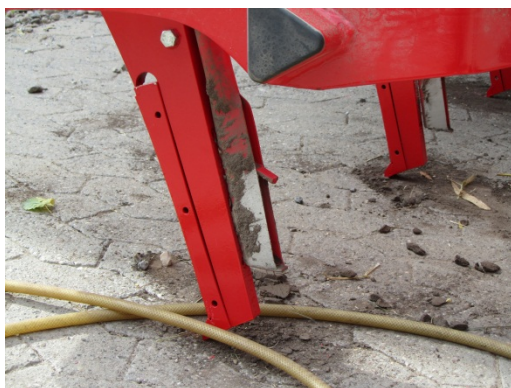
Billede 63. Gødningsudløb kan justeres på tanden.
